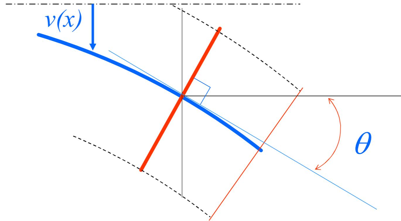
変形後の断面は材軸に直交
