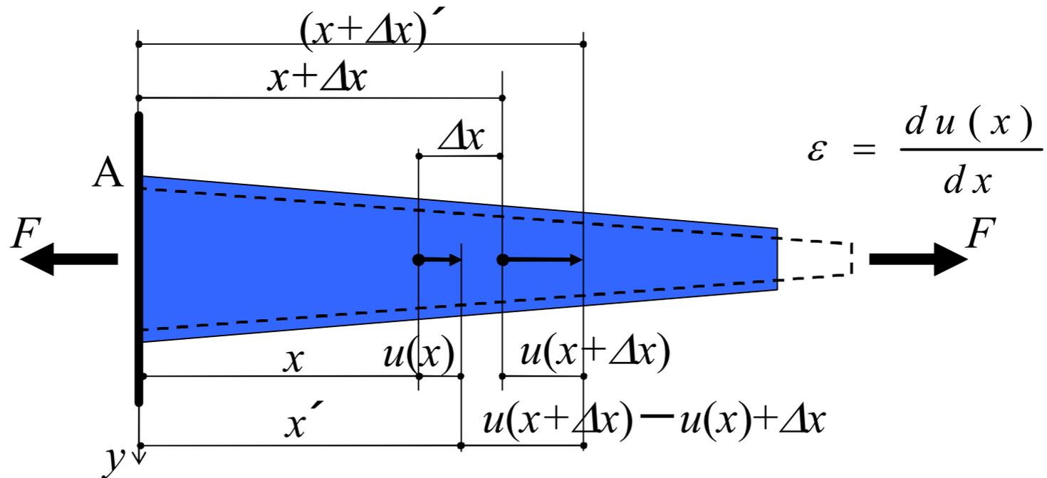
Aから $x$ 離れていた点は $x'$ に、Aから $(x+\Delta x)$ 離れていた点は $(x+\Delta x)'$ に移動したとする。このとき、点 $x$ の変位 $u(x)$ は、
