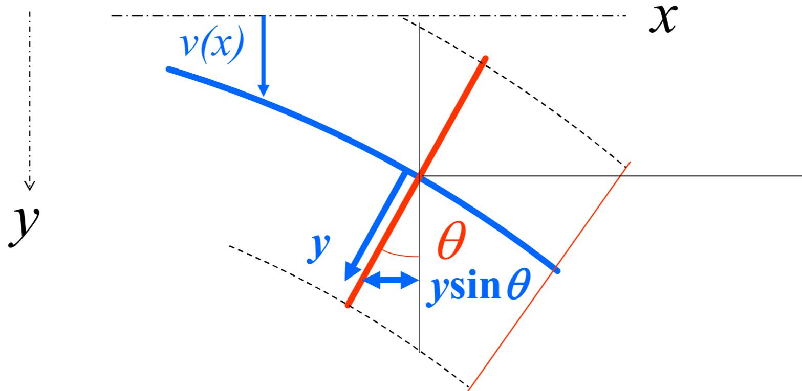
重心軸の $y$ 方向変位を $v(x)$ とすると, 重心から $y$ だけ離れた点の $x$ 方向の変位は,  $y v'(x)$ となる.
