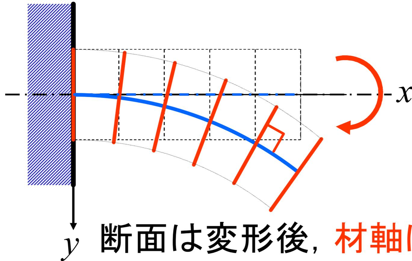
断面は変形後、材軸に直交する全く同じ平面に移る。
