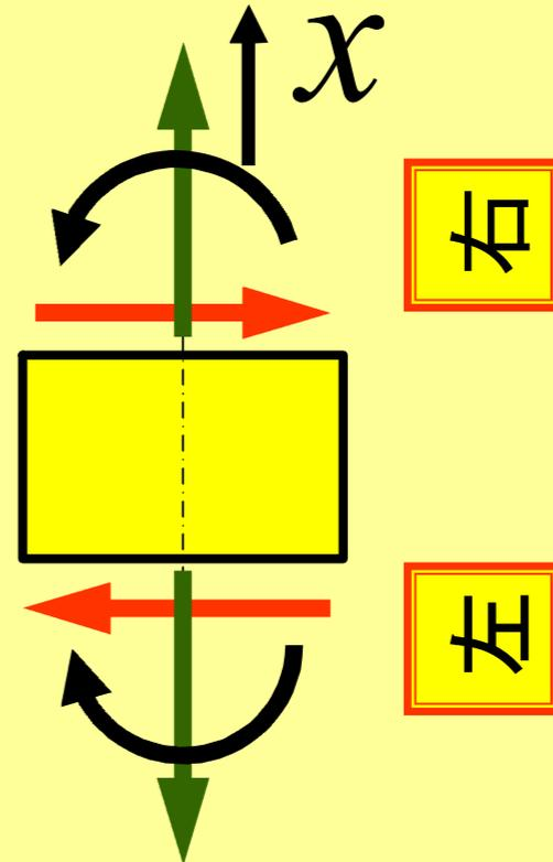
柱のように材軸が鉛直方向になった時,  $Q$ ,  $N$  の方向はどちらの面を左としても同じだが,  $M$  は方向が変わる.
