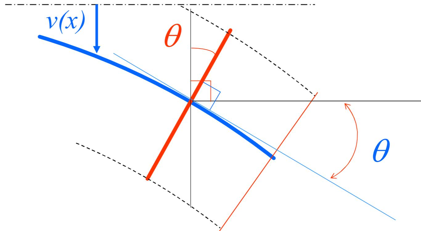
変形後の断面と鉛直軸の角度
