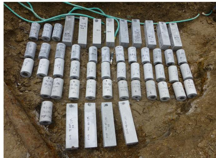
試験体の埋設状況
