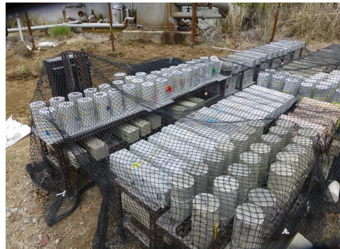
試験体の気中暴露状況
